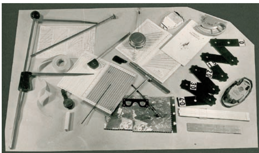
Vybavení pracovníků pro inventarizaci lesů, 1973 (např. kovová průměrka, výškoměr BLUME-LEISS, přírůstový nebozez, zrcadlový relaskop a relaskopický klin, samonavíjecí pásmo EIA BUSHMAN, taxační průvodce). Equipment for forest inventory workers, 1973 (e.g. metal calliper, BLUME-LEISS height meter, Pressler's increment auger, mirror relascope and wedge prism, EIA BUSHMAN self-winding tape, enumeration guide).
