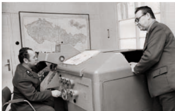
Vyhodnocování leteckých snímků na přístroji Zeiss Stereometrograph. ÚHÚL, 80. léta 20. století. Evaluating air photos on the Zeiss Stereometrograph. FMI, 1980s.
