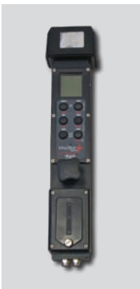
MapStar – přístroj pro měření absolutních horizontálních úhlů – používá se k zaměřování polohy stromů a při navigaci.
