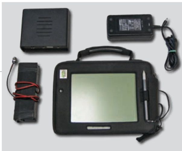
Terénní počítač Hammerhead P-233 s externími olověnými bateriemi a nabíječkou.
