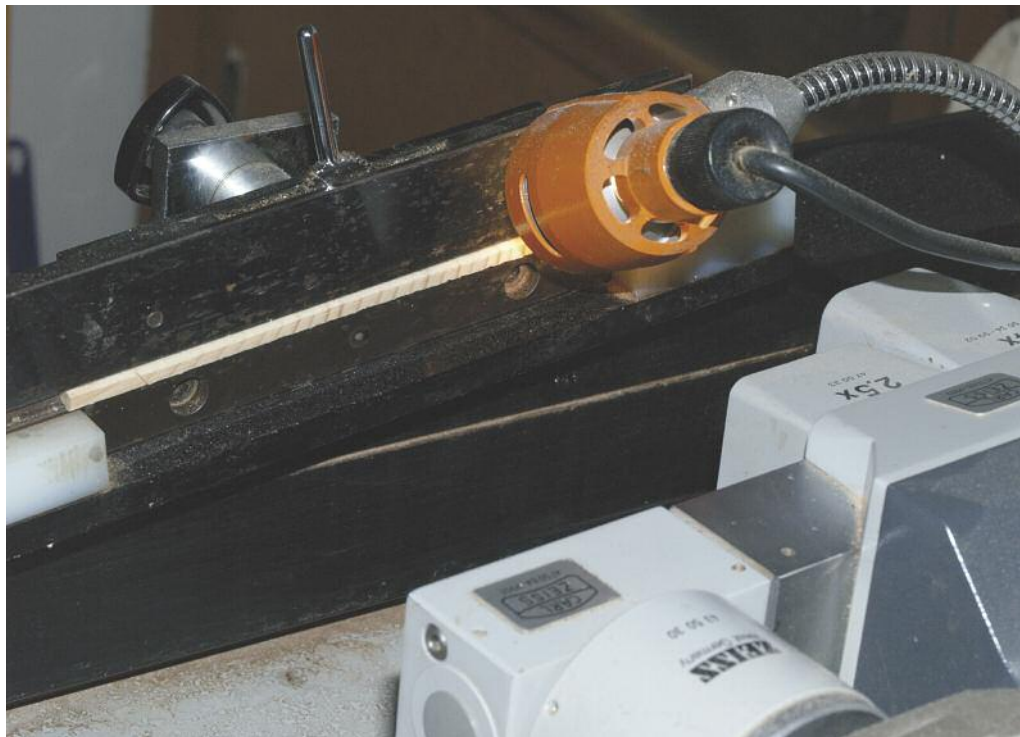
Der Digitalpositiometer des Instituts für Waldwachstum und Waldbau bei der Messung von Bohrkernen
