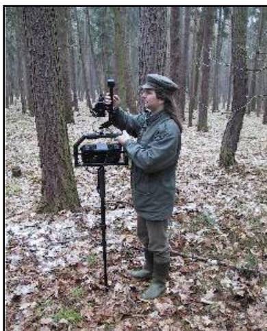
Obr. 4.4.2 Určení expozice pomocí elektromagnetického kompasu
