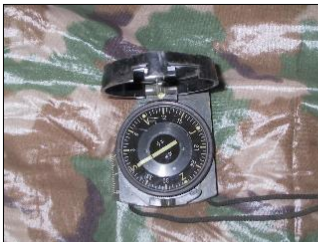
Obr. 4.4.3 Určení expozice pomocí kapesní buzolky
